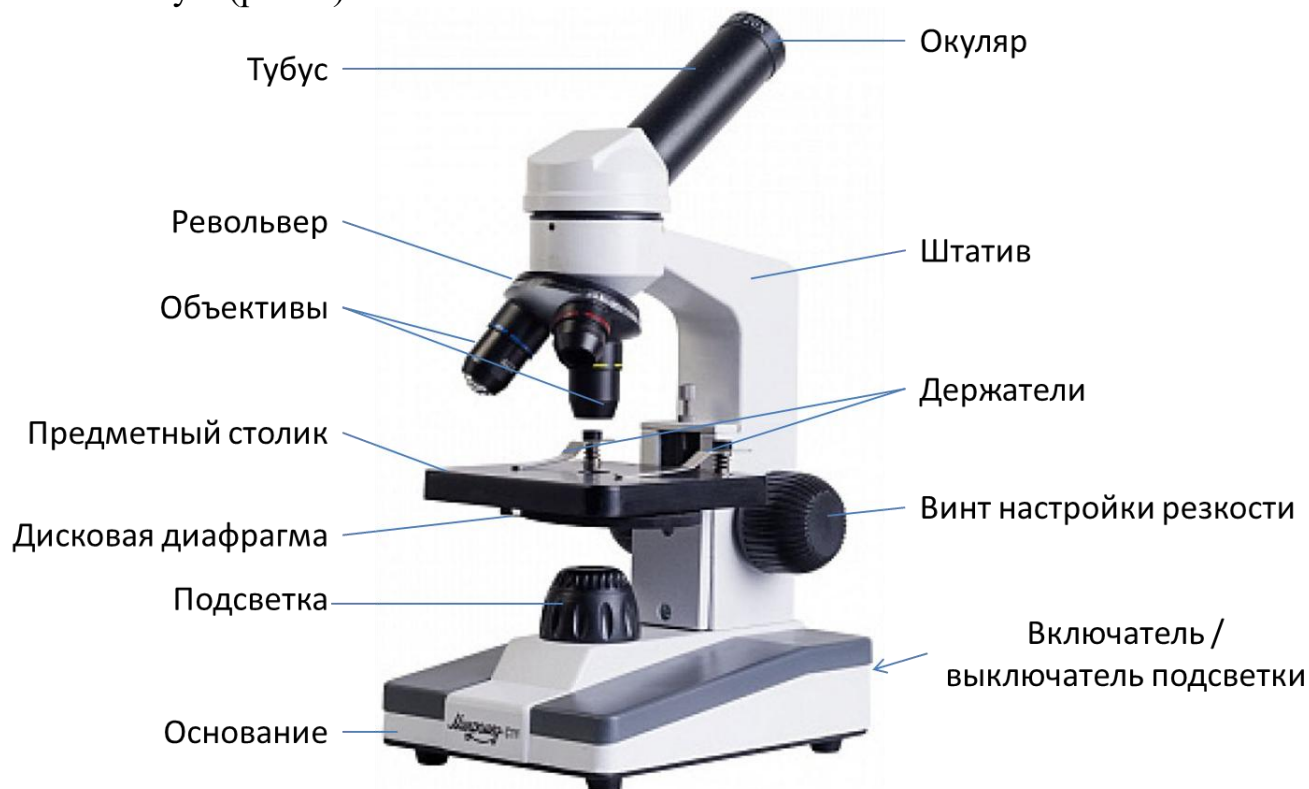
Рис. 1. Схема строения светового микроскопа «Биолаб С-15»
