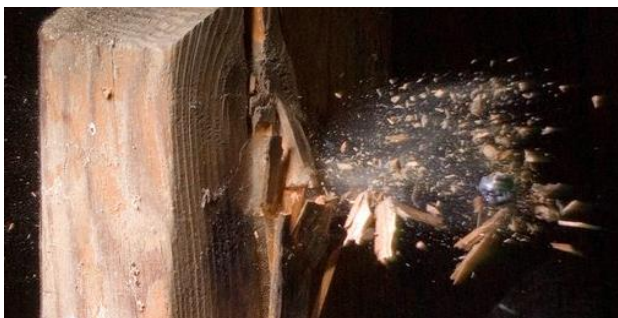
Рис. 12. Внешний вид повреждения в преграде
